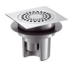
Débit 36 l/min normalisé. Garde d'eau 50 mm. Platine et grille Inox poli brillant 150 x 150 mm. Sortie horizontale ou verticale Ø 40 intégrée dans la hauteur du siphon (gain de hauteur et orientation toute direction). Collerette d'étanchéité intégrée pour collage de membrane isolante.
