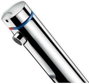
Déclenchement souple. Réglage de la température et déclenchement sur le croisillon. Temporisation ~7 secondes. Débit pré-réglé à 3 L/min à 3 bar, ajustable de 1,5 à 6 L/min. Brise-jet antitartre inviolable. Corps en laiton massif chromé.
