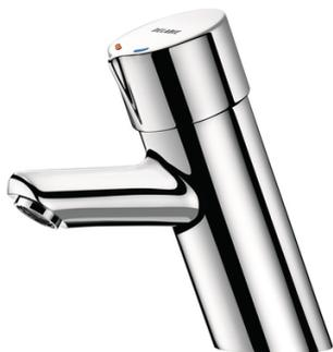
Mitigeur de lavabo temporisé monocommande sur vasque : Déclenchement souple. Réglage de la température et déclenchement sur le croisillon. Temporisation ~7 secondes. Débit pré-réglé à 3 l/min à 3 bar, ajustable de 1,4 à 6 l/min. Brise-jet antitartre. Corps en laiton massif chromé. Flexibles PEX F3/8" avec robinets d'arrêt, filtres et clapets antiretour. Fixation renforcée par 2 tiges Inox. Butée de température réglable. Croisillon ergonomique en métal chromé. Garantie 10 ans.
