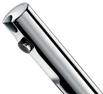
Alimentation par piles 123 Lithium 6 V intégrées. Electrovanne antistagnation et module électronique intégrés dans le corps de la robinetterie. Débit préréglé à 3 l/min à 3 bar, ajustable de 1,5 à 6 l/min. Brise-jet antitartre. Rinçage périodique (~60 secondes toutes les 24 h après la dernière utilisation). Détection de présence infrarouge actif, optimisée en bout de bec.
