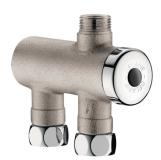
Mitigeur thermostatique pour distribution d?eau mitigée de 34 à 60°C : Alimentation de 1 à 2 robinets ou 1 douche. Sécurité antibrûlure : fermeture automatique en cas de coupure d?eau froide ou d'eau chaude. Température préréglée à 38°C, ajustable par l?installateur entre 34 et 60°C.
