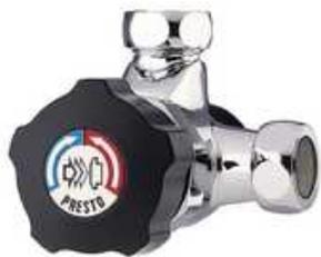
Pression d'utilisation recommandée : 1 à 5 bars. Débit : 8 l/mn avec régulateur de débit intégré. Dispositif anti-coup de bélier. Durée d'écoulement : 30 secondes (- 10 / + 5 secondes)
