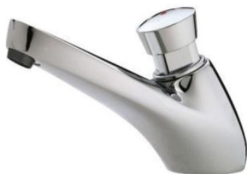
Pression d'utilisation recommandée : 1 à 5 bars. Débit : 3 l/mn à 3 bars - réglage 4 positions, dispositif anti-coup de bélier. Durée d'écoulement : 15 secondes +/- 5 secondes. Alimentation hydraulique : Mâle G 1/2" (15x21) en eau froide ou pré-mitigée.
