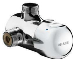
Mitigeur de douche temporisé apparent : Mitigeur TEMPOMIX 3/4" monocommande. Installation murale en applique. Réglage de température et déclenchement sur le croisillon. Butée de température maximale (réglable par l'installateur). Déclenchement souple. Temporisation ~30 secondes. Débit 12 l/min à 3 bar, ajustable. Laiton massif chromé. Filtres et clapets antiretour intégrés. Croisillon en métal chromé. Arrivées en ligne, entraxe 90 mm. Garantie 10 ans.
