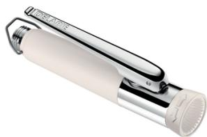
Douchette blanche à jet réglable et embout antichoc. Diffuseur antitartre (buse sans grille). Deux types de jets : jet pluie 8 l/min à 3 bar et jet concentré 9 l/min à 3 bar. Manche recouvert en Polypropylène renforcé et antidérapant (meilleure préhension). Laiton massif chromé. Possibilité de blocage de la douchette en position ouverte grâce au collier.
