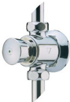
Pression d'utilisation recommandée : 1 à 5 bars. Débit : 30 l/mn à 1 bar. Réglage par bague du débit. Dispositif anti-coup de bélier. Alimentation hydraulique : Alimentation en ligne. Entrée/Sortie mâle G 3/4" (20x27). Les robinets PRESTO 60 et PRESTO 60 B sont livrés en sortie d'usine, bague vissée pour libérer la section maximale de passage d'eau. Livré avec : 1 joint plat et 1 écrou raccord, 1 Ecrou pour tube 16x18, 1 Rosace solidaire du robinet.
