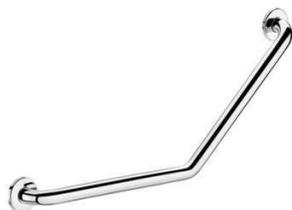
Barre d'appui coudée à 135° Ø 32, pour PMR, 2 points de fixations. Utilisation comme barre d'appui (partie horizontale) ou de relèvement (partie à 135°) pour WC, douche ou baignoire. Utilisation indifféremment à gauche comme à droite. Tube inox 304 bactériostatique. Finition inox poli brillant UltraPolish, surface sans porosité et homogène facilitant l'entretien et l'hygiène.
