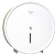
Épaisseur de l'acier 1,2 mm. Fermeture du capot sécurisée par vis BTR. Fenêtre de visualisation de niveau. Mandrin universel avec frein mousse anti bruit. Découpe facile du papier droite ou gauche. Appareil anti vandalisme à usage intensif pour les lieux publics. Contenance : 1 rouleau 700 m 1 pli ou 400 m 2 plis. Dimensions : diam. 302 mm - Profondeur 127 mm.
