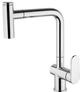
Mitigeur évier avec douchette. Cartouche Ø 35 mm. Douchette ABS 2 jets, flexible nylon 1,20 m avec contre-poids. Mousseur anti-calcaire. 2 flexibles de raccord. inox 370 mm.
