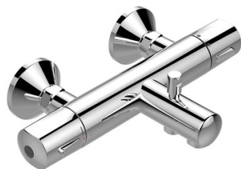
Elément thermostatique à cire avec grille anti tartre. Tête 1/2" à disque céramique. Croisillon de température avec butée de sécurité à 40°C débrayable.
