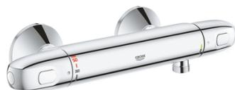
Mitigeur thermostatique Douche 1/2" Montage mural apparent. Cartouche C3 - régulation thermostatique quasi-instantanée. GROHE MetalGrip poignées ergonomiques en métal - GROHE SafeStop butée à 38°C + limiteur de température intégré à 50°C max. Poignée de débit avec touche éco et butée éco réglable séparément.
