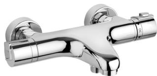
Anticalcaire avec filtres. Cartouche thermostatique C3. Limiteur de température anti-brûlure réglable. Raccords excentriques et rosaces laiton Ø 60 mm.
