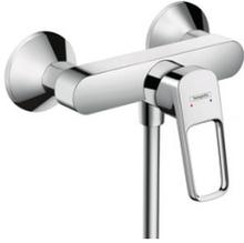
Mitigeur douche C2 avec cartouche 2 vitesses chromé. 1 sortie = 1 fonction. Type de raccordement : raccords S. Entraxe: 150 mm  $\pm$  12 mm. Débit maximal sous 3 bars de pression: 22 l/min. Cartouche céramique à 2 vitesses. Limiteur de température réglable. Clapet anti-retour. Avec silencieux. E1, C2, A2, U3.
