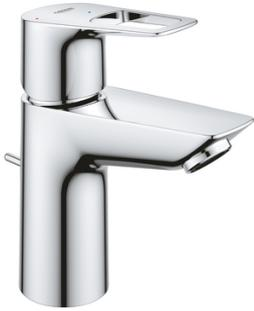
Mitigeur chromé monotrou sur plage. Levier de commande métallique. GROHE Long-Life Économie d'énergie Cartouche en céramique 28 mm. Avec ouverture eau froide au centre. Avec limiteur de température. GROHE Brillance Longue Durée. Conduit d'eau interne sans plomb ni nickel. GROHE Économie d'eau mousseur 5 l/min. Système d'installation rapide. Garniture de vidage matériau synthétique 1 1/4". Flexibles de raccordement souples.
