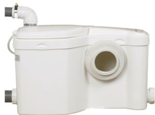
Broyeur adaptable W12. Ø d'entrée : 100 mm pour le WC et 40 mm pour les lave-mains et douches. Ø de sortie : 32 mm. Puissance 470 W. Broyage par râpe. Dimensions : 435 x 215 x 330 mm
