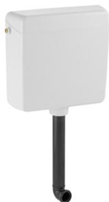
Pour une installation dissimulée derrière une cloison, en basse position combiné à un wc au sol. Convient pour un déclenchement pneumatique à distance simple ou double chasse. Coque et couvercle en ABS blanc. Equipé d'un robinet flotteur type 380 silencieux. Alimentation latérale droite ou gauche. Livré avec les fixations et le coude de chasse encastré 38x5,2cm et un diamètre de 50/44mm.
