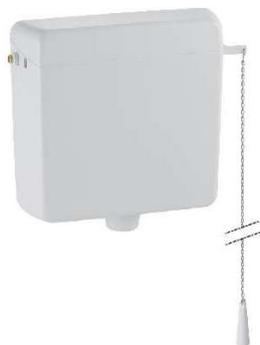
Réservoir 6/9 litres à chaînette. Pour le montage haute position, déclenchement mécanique à distance. Silencieux. Rinçage simple touche. Couvercle de la chasse d'eau sans touche de déclenchement. Plage de réglage: 6/9 L. Livré avec : Chaînette, modérateur de débit, matériel de fixation.
