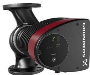
Circulateur à haut rendement énergétique, conçu pour la circulation de liquides au sein d'applications suivantes : chauffage, climatisation, eau chaude sanitaire et systèmes de pompes géothermiques. Hauteur maxi : 18 m. Débit maxi : 70 m<sup>3</sup>/h. Puissance maxi : 1550 W. Température du liquide de -10°C à +110°C. Température ambiante : 0°C à +40°C. Pression de service nominale : 6/10/16 bar. Corps de pompe en fonte.
