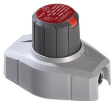
Pression d'entrée : 525 à 1950 mbar. Pression de sortie : 37 mbar. Entrée - sortie : mâle 20 x 150. IP55. Conforme aux exigences des normes NF EN 16129 et NF M 88-781. Indicateur visuel de sécurité Safetyscope. Robinet de coupure manuelle en un clic. Détendeur 2ème étage basse pression. Interchangeabilité. Recommandé pour une utilisation en cuisson, chauffage, eau chaude.
