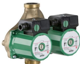
Ce circulateur convient seulement pour l'eau potable. Circulateur d'eau chaude sanitaire, circulateur double à rotor noyé dans un corps commun, avec volet directionnel, pour installation en ligne, avec raccord fileté, moteur autoprotégé et commutation manuelle de la vitesse 3 niveaux. Corps de pompe en bronze, roue en plastique, arbre en céramique, palier lisse en carbone imprégné de résine.
