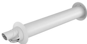
Le terminal horizontal blanc autorise une grande longueur de conduit pour aller déboucher sur la façade choisie. Livré avec plaques anti-goutte extérieures et une rosace intérieure en PE blanc. Conduit extérieur en PVC pour traverser la paroi sans fourreau.
