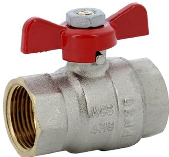
La vanne à sphère 586 Sferaco Laiton titré CW617N série Bâtiment+, ACS 4MS, pour utilisations en chauffage sanitaire, eau potable, climatisation, arrosage et irrigation. Passage intégral et portée plate large, manette papillon rouge.
