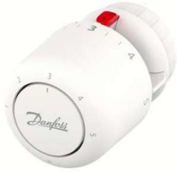
Plage de réglage 5 à 26°. RA 2990 : Bulbe incorporé, Vt 0.5K, temps de réaction 10 min. RA 2992 : Bulbe à distance (0 à 2 m), temps de réaction 8 min.
