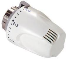
La tête thermostatique Sensity allie les meilleures performances sur le marché (Précision et réactivité) avec un design moderne. Son capteur liquide et ses aérations au nouveau design font de ce modèle un des plus performants techniquement. Vt (k) : 0,2. Aucun outil n'est nécessaire au montage ni à l'utilisation de la limitation de la température de la tête.
