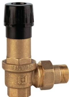
La soupape différentielle se monte en by-pass, entre le départ et le retour à la chaudière, après l'accélérateur.
