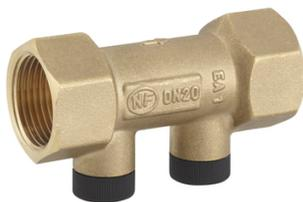
Clapet antipollution contrôlable pour tous les réseaux d'eau potable avec écrou tournant pour montage direct après compteur. Comprend : Corps laiton muni de 2 bossages. Bouchons polyamide. Clapet polyacétal (POM). Ressort acier inox. Joint NBR (nitrile). Clapet antipollution contrôlable avec écrou tournant pour montage direct après compteur. Comprend : Corps laiton muni de 2 bossages. Bouchons polyamide noirs. Clapet polyacétal (POM). Ressort acier inox. Joint NBR (nitrile).
