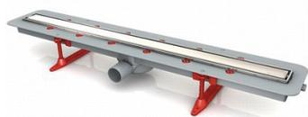
Doté d'un corps de base soudé en ABS, le caniveau de douche Linearis Compact est adapté à un écoulement linéaire en intérieur. La plaque en acier inoxydable posée à l'envers est carrelable à souhait. Avec encoches d'infiltration préparées et dispositif anti-odeur.
