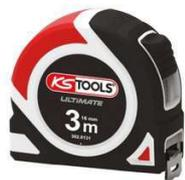
Ruban en acier blanc avec traitement nylon anti-usure de classe II. Graduation millimétrique des deux côtés et recto verso. Enrouleur et arrêt automatiques. Boîtier en ABS bi-composant. Equipé d'une dragonne et d'un clip de ceinture.
