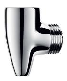
Raccord antistagnation en laiton massif chromé pour vidange automatique du flexible de douche et de la douchette. Empêche toute stagnation d'eau et limite la prolifération des bactéries. Arrivée F1/2" avec joint filtre à raccorder sur la sortie basse de la robinetterie. Sortie M1/2" à raccorder au flexible.
