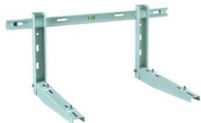
Support mural de climatisation avec niveau. Charge max : 160 kg. Longueur des bras : 550 mm. Acier galvanisé. Epaisseur 1,5 mm. Peinture époxy : blanc ivoire RAL 9002.
