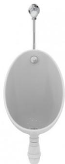
Pack urinoir complet prêt à poser comprenant : Un urinoir de face en porcelaine vitrifiée - Sans bride - Robinet temporisé alimentation apparente droite (réglage du débit sans démontage) - Tube et douille d'alimentation - Bonde - Siphon - Vis de fixation - Poids : 8 kg - Hauteur: 400 mm - Largeur: 290 mm - Longueur : 315 mm - Montage : Mural - Blanc brillant. Avantages : Esthétique arrondi - Lignes courbes sans recoin pour facilité le nettoyage
