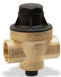
Réduit, Régule et Sécurise la pression. Economise l'eau et l'énergie. Conformité sanitaire. Réglage simple de la pression aval de 1,5 à 5,5 bar. Prise manomètre 1/4" gaz. Siège en Inox.
