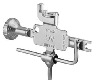
Pour le réglage de la valeur de consigne de température à la tête thermostatique «Uni LHB», le pré-réglage du robinet et le démontage de la poignée graduée des têtes thermostatiques «Uni LH», «Uni LHZ», «Uni LD», «Uni LDV», «Uni LDVL», «Uni L» et des têtes thermostatiques spéciales. Avec clé à six pans (2,5 mm) additionnelle pour la protection de la tête thermostatique «Uni LHB».
