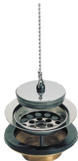
Cette bonde à bouchon-chaînette est destinée à un évier percé en diamètre 50 mm et sans trop plein. La cuvette en inox a un diamètre de 70 mm. Le serrage est possible de 0 à 10 mm. La vis est en inox. Le bouchon noir permet d'obstruer l'orifice avec son diamètre de 45 mm.
