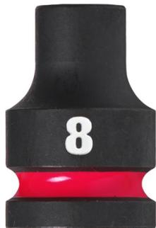
L'acier (Chrome-Molybdène) SHOCKWAVE? IMPACT DUTY est un alliage en acier de haute qualité qui fournit une force extrême et une grande durabilité. Meilleure adaptation grâce aux 6 points de fixation. Aucun glissement grâce à sa géométrie hexagonale pour protéger la forme de la douille et de l'écrou. Construction à parois affinées pour un meilleur accès. Marquage du diamètre estampée et rempli d'encre numéro de pièce gravé au laser. Double trou pour les associer avec les accessoires de sécurité.
