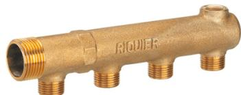
Entraxe 50 mm. Diamètre du corps 32 mm. Epruvé à 10 bar. Collecteur laiton arrivée mâle 26x34, Départ 15x21 bouché à purge 3/8.
