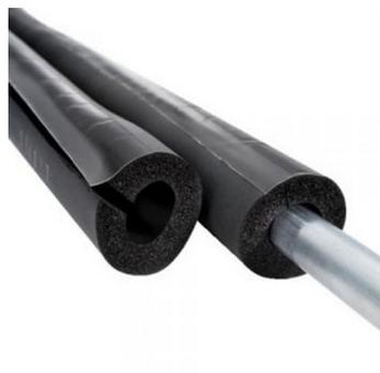
INSUL-TUBE® L-REC est un matériau isolant souple en mousse à cellules fermées à base de caoutchouc, doté d'une bande de recouvrement avec adhésif en PVC. Les très bonnes propriétés d'isolation thermique permettent de réduire considérablement la consommation d'énergie pour le fonctionnement des installations sanitaires et de chauffage.
