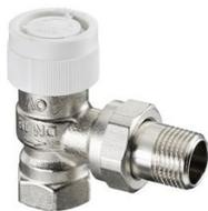
Modèle équerre. Réglage rapide AV 9 avec 17 valeurs intermédiaires. Pour installations de chauffage bitubes. Laiton nickelé. Testé et approuvé selon EN 215/ KEYMARK. En période de service : entretien avec Demo-Bloc.
