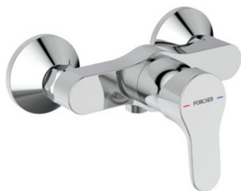
Mitigeur douche mural. Sortie de douche 1/2" par le dessous avec clapets anti-retour intégrés. Cartouche Firmaflow® Ø 38 mm à 2 disques céramique, avec limiteur de température intégré et limiteur de débit 50 % déverrouillable. Rosaces métal coniques. Raccords muraux
