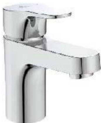
Mitigeur lavabo monotrou Olyos chrome. Bec fixe avec aérateur intégré. Tirette courbée en métal. Cartouche Firmaflow® Ø 38 mm avec limiteur de température intégré et limiteur de débit 50 % déverrouillable. Flexibles anti-torsion PEX 3/8" - 350 mm.
