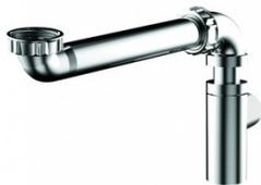
Tubulure de raccordement et siphon design, aspect chromé, gain d'espace pour lavabo. Sortie diamètre 32 mm, réglable en hauteur et en profondeur. Installation rapide : adapté à tout type de lavabo ou vasque. Garde d'eau 50 mm.
