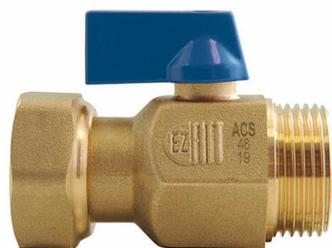
Idéal pour montage sur collecteur et tout accessoire de robinetterie en laiton. Laiton CW617N 4MS. Sièges PTFE. Double joint torique EPDM. Poignée aluminium bleue. Vis en laiton. Filetage ISO 228-1 (BSPP). Portée de joint plate à chaque extrémité pour étanchéité par joint plat. Axe inéjectable. Grand diamètre de passage, débit supérieur. ACS.
