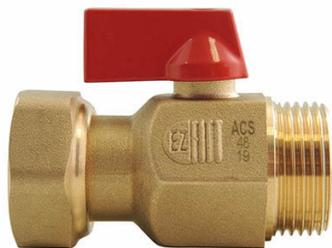
Idéal pour montage sur collecteur et tout accessoire de robinetterie en laiton. Laiton CW617N 4MS. Sièges PTFE. Double joint torique EPDM. Poignée aluminium rouge. Vis en laiton. Filetage ISO 228-1 (BSPP). Portée de joint plate à chaque extrémité pour étanchéité par joint plat. Axe inéjectable. Grand diamètre de passage, débit supérieur. ACS.
