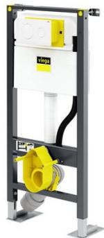
Élément WC suspendu, cadre en acier 40 cm. Réservoir de chasse moulé 1 seule pièce. Rinçage 2 volumes. Livré avec plaque de commande blanche.
