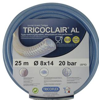
Tuyau renforcé polyvalent alimentaire et très performant. Conception tri-couches très résistante, en pvc souple transparent de classe a et sans phtalates, avec renforcement en fibre polyester haute ténacité. Tuyau polyvalent adapté à de nombreux usages : Alimentation de machines et d'outillages en air comprimé, passage de gaz industriels, passage de produits alimentaires, transfert de certains produits chimiques et refoulement d'eau (traitement des eaux).
