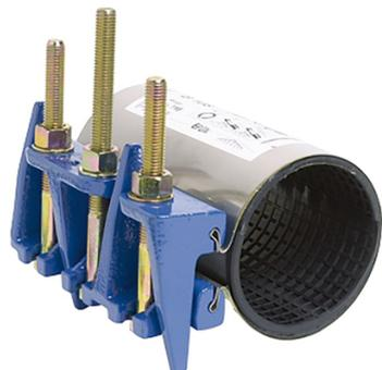
Certifié ACS 4MS type B, 3 tirants longueur 200 mm avec joint EPDM, enveloppe inox, pour réseaux de distribution et d'adduction d'eau potable
